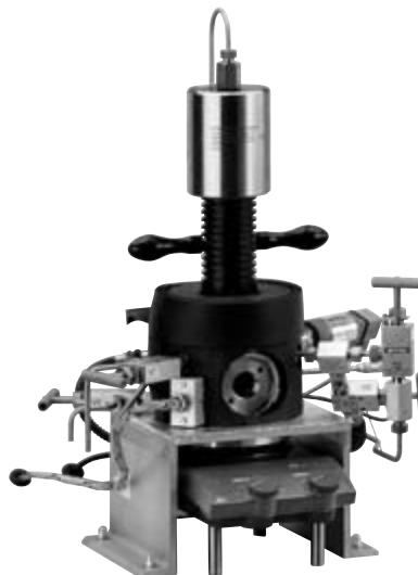
Druckausgeglichene Sichtzelle mit Magnetrührer, Endoskop, Kamera, Drucktransmitter und zwei Probenahmeverventilen.
