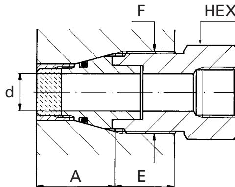
**Metallische Konusdichtung – Cone-to-cone closure – Joint métallique cône sur cône**
