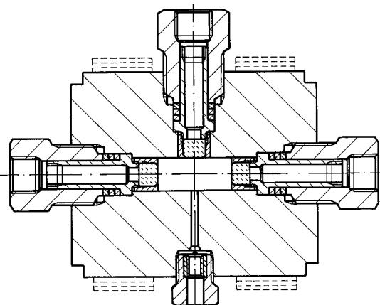
**Sichtzellen in Rundprofil – Round optical cells – Enceintes optiques rondes**
