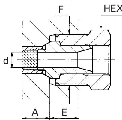
**Bridgman-Dichtung – Bridgman closure – Etanchéité système bridgman**
